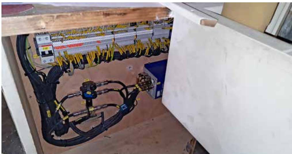
Obr. 17. Slovenská strela, instalace integrovaného palubního zabezpečovače Mirel RM-2, jehož řídicí jednotka se umístila v kuchyňce pod pracovní stůl, zdroj: RMK, fond Sbírka vlastivědného materiálu, foto: autorka, 2020
