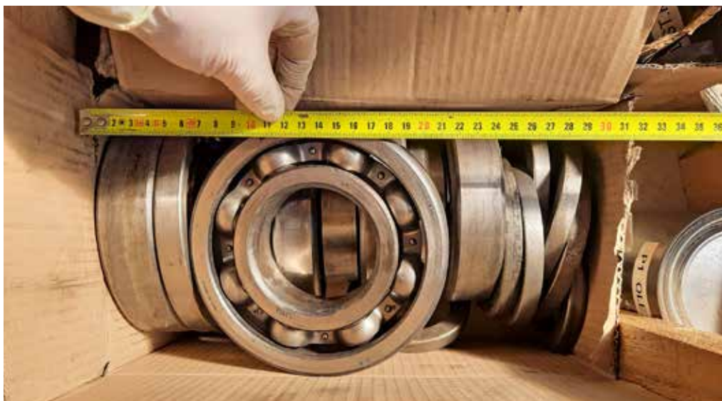
Obr. 20. Slovenská strela, demontovaná ložiska SKF, uložené v depozitári, zdroj: RMK, fond Sbirka vlastivědného materiálu, foto: autorka, 2021
