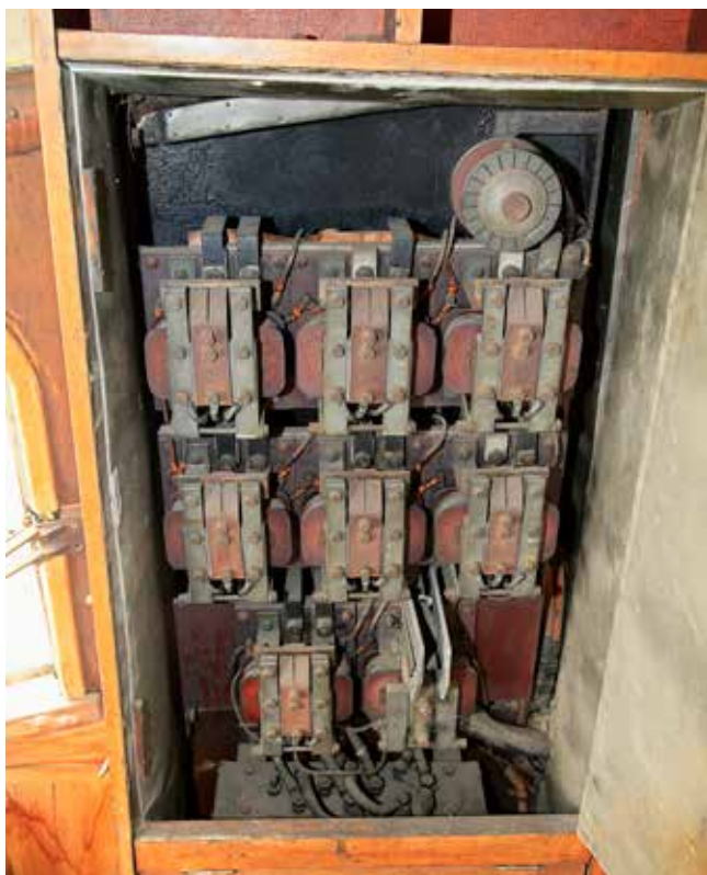
Obr. 15. Slovenská strela, stav elektroinstalace před restaurováním, zdroj: RMK, fond Sbírka vlastivědného materiálu, foto: autorka, 2018
