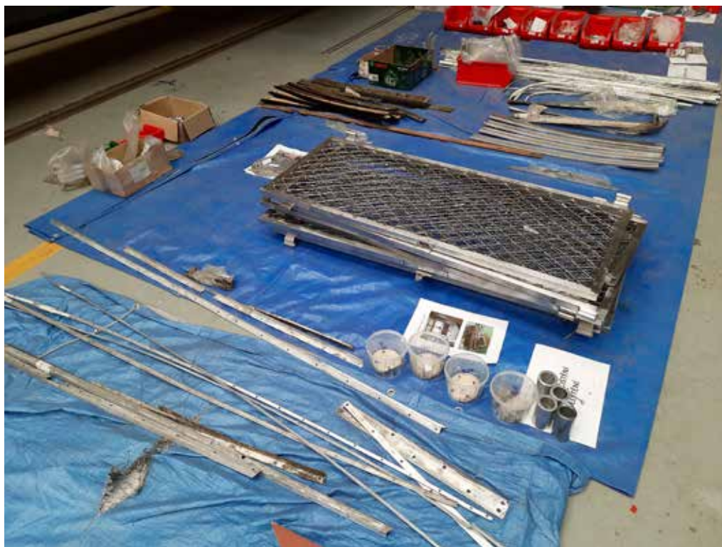
Obr. 13. Slovenská strela, původní mříž po povrchové úpravě poniklováním a další součásti, které se při kompletaci vozu vracely, zdroj: RMK, fond Sběrka vlastivědného materiálu, foto: autorka, 2020
