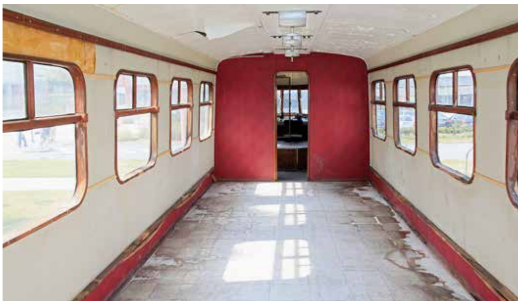
Obr. 11. Slovenská strela, stav interiéru před restaurováním – oddíl pro kuřáky, který byl dříve upraven pro expozici o železnici, na podlaze linoleum, zdroj: RMK, fond Sběrka vlastivědného materiálu, foto: autorka, 2018
