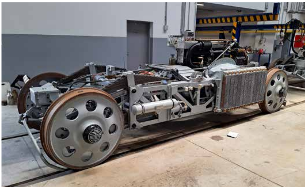
Obr. 19. Slovenská strela, restaurovaný podvozok s motorem T 68, ještě s původními koly před zahájením zprovoznění pohonu, zdroj: RMK, fond Sbírka vlastivědného materiálu, foto: autorka, 2020
