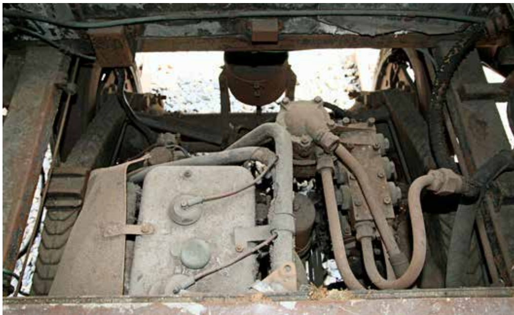
Obr. 18. Slovenská strelа, horní pohled na část podvozku s benzínovým motorem T 68 v nálezovém stavu, zdroj: RMK, fond Sbirka vlastivědného materiálu, foto: autorka, 2018
