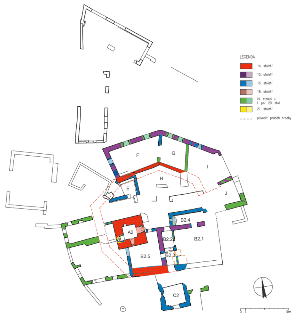
Obr. 20. Pasovary, bývalá tvrz, půdorys prvního patra s vyhodnocením stáří konstrukcí. Geodetické zaměření: CePT, s.r.o., 2019, vyhodnocení: Daniel Šnejd, 2023
